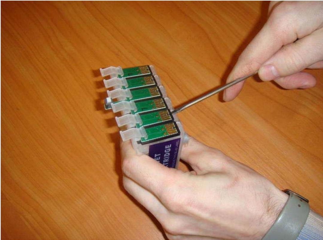
2. При этом один край шлица отвертки упереть в корпус картриджа, другой – по центру пластмассового кожуха, не допуская перекоса кожуха либо платы (на фото левее от отвертки – высвобожденные из защелки элементы платы).
