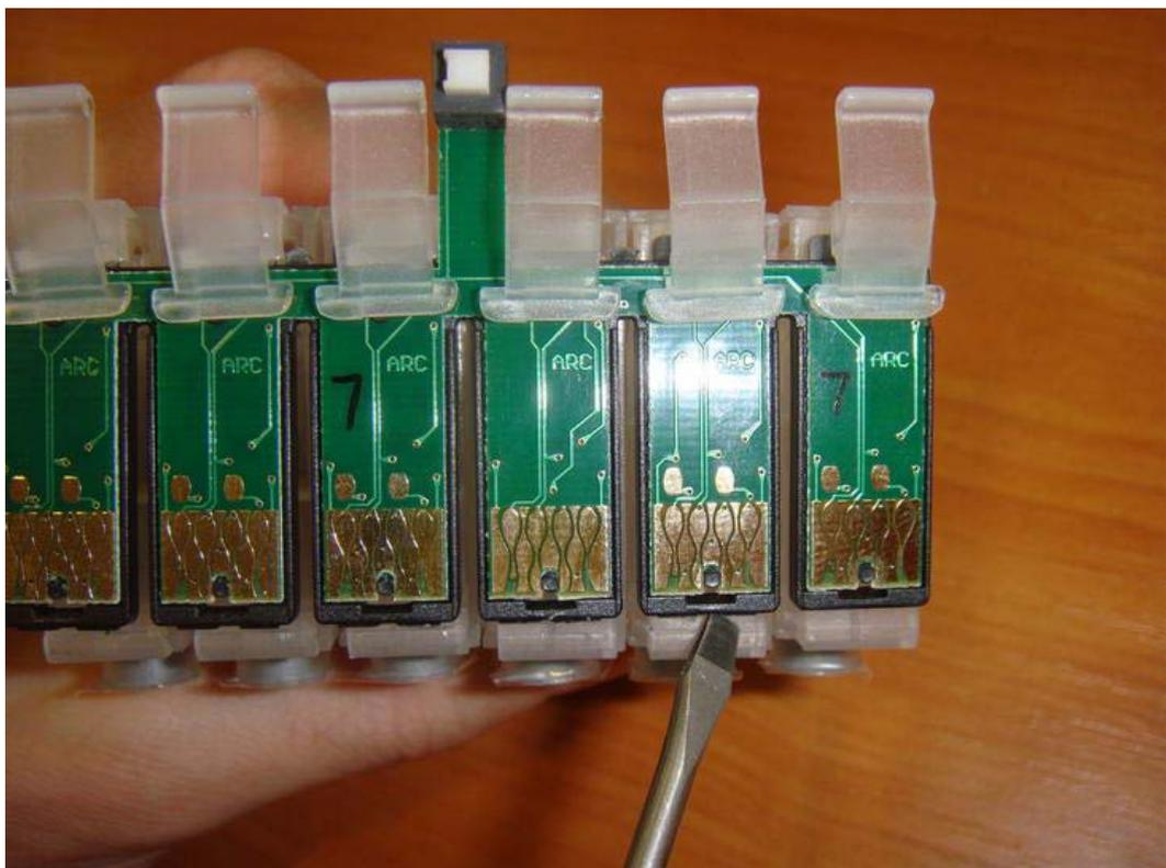
3. Далее немного поворачиваем плату, выводим кнопку сброса между элементами крепежа картриджей. Работать нужно аккуратно, не допуская перегиба платы в районе кнопки сброса.
